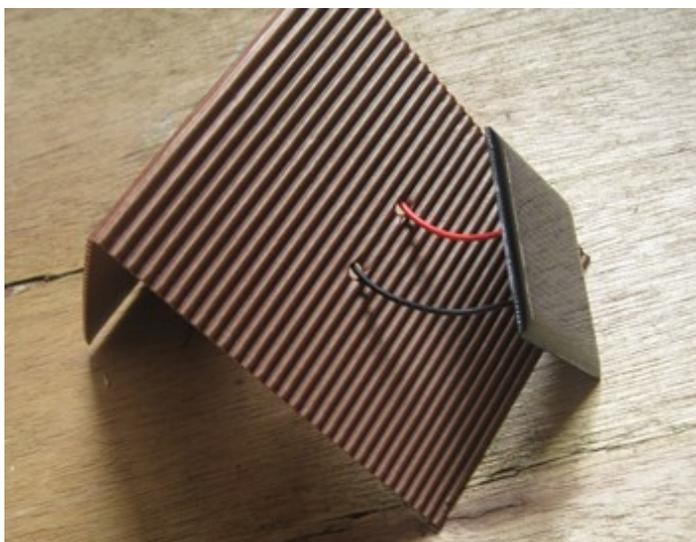
**4.** Für das Dach eine 18 cm x 8 cm große Pappe zuschneiden, in der Mitte knicken und auf einer Seite im Abstand von 2 cm zwei Durchführungslöcher für die Kabel der Solarzelle bohren.
